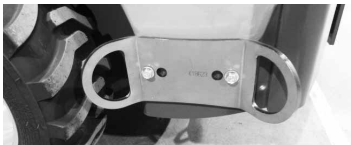
Staffa di ancoraggio A418623 installata lateralmente al telaio posteriore. Per l'installazione laterale, sono necessarie due staffe.
