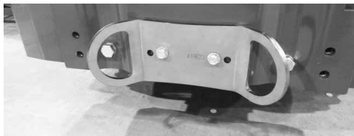
Staffa di ancoraggio A418623 installata sul paraurti posteriore o sul contrappeso
